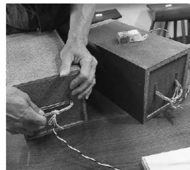
裏板は動かせるようにして、容積を調整しながら聴いていく
