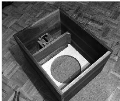
オール無垢キャビ内部。ホーン部もウォールナットという贅沢ぶり
