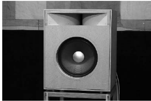
前回はトゥイーターにホーンをつけ、エンクロージャ内部に納めた。(トゥイーターはパツフルより18cm奥の位置)
