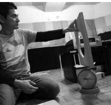
それぞれのパツフル板の重量を計測
