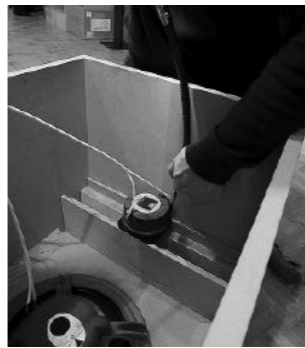
ホーントウイーターを固定する岸氏。曲がるビットを装着して細かいところもネジどめ
