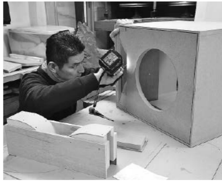
トウイーターを内部に組込むべく、ホーンを製作中の岸氏
