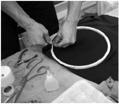
木で作ったリング状のフレームにネットを糊付けし、タッカーで固定する
