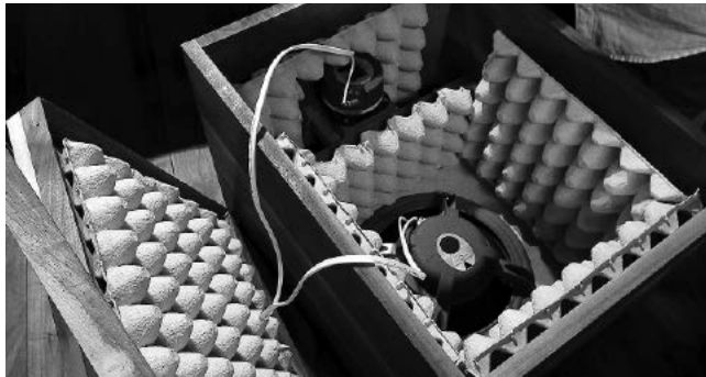
前回は定在波対策として、全面に卵パックを貼り付ける事に行き着いたが、暴れていた音が整うとまた別の不満が湧いてきた
