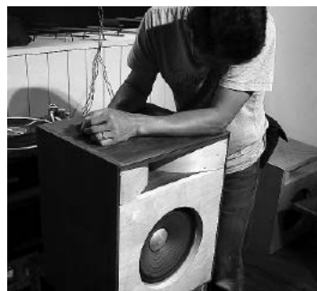
やったり、スリットからの音が気になる…。適度に風圧を抑えるため、隙間にステンレスたわしを詰め込む
