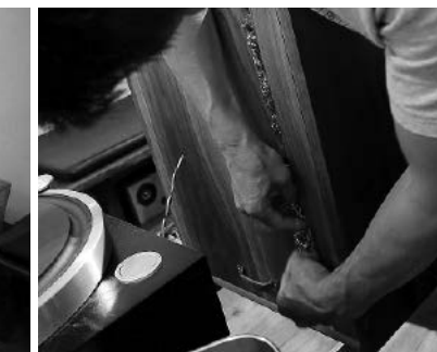
やったり、スリットからの音が気になる…。適度に風圧を抑えるため、隙間にステンレスたわしを詰め込む
