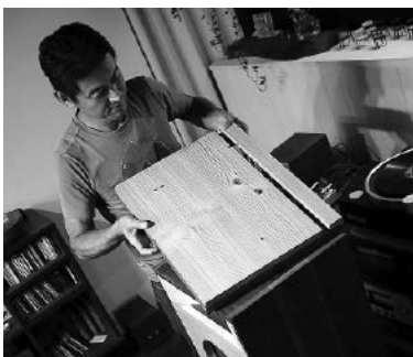
エンクロージャーで最も振動している裏板を、松の無垢 10時間にも及ぶ試聴&実験。いったい何が正解なのか。途中にくれる我々
