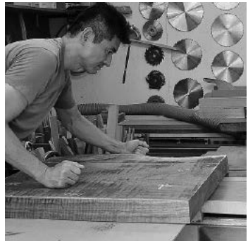
裏板を丸ノコで大胆にカット！ 密閉からスリットパスレフに
