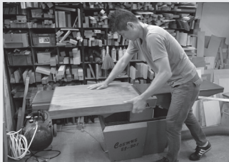
手押しかん盤で表面をフラットにする
