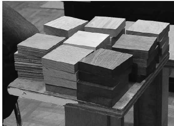
各4セット同じサイズ(90×90×22mm)でカットした、インシュレーターを聴く
