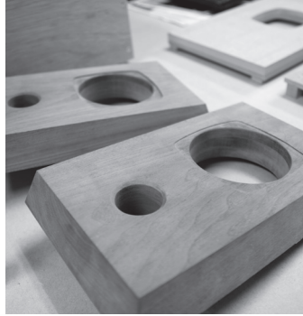
スピーカーユニットのフレームがツライチになるよう、ざぐってある。これにより、見た目の高級感が増す
