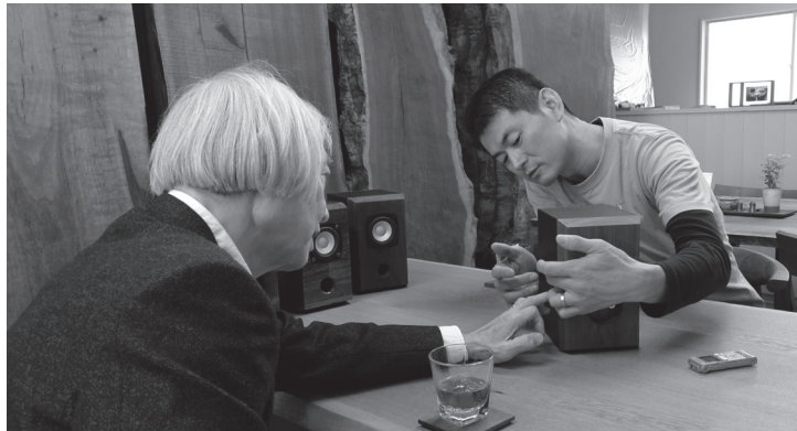
レザーの張り具合や位置、パッフルに対しての高さなど、細かな微調整を何度も行なう
